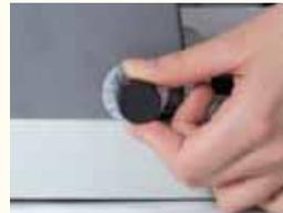
An der Einstellskala wird der Durchmesser zum Schließen eingestellt.
